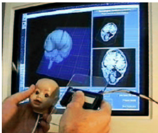
FIG. 2.4 – Utilisation d'une tête de poupée et d'un plateau transparent pour simuler les mouvements d'une tête virtuelle et d'un plan de coupe
