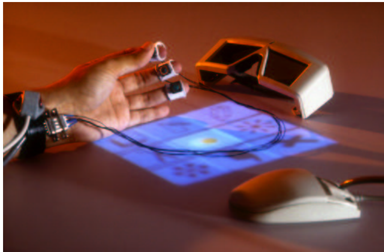
FIG. 3.4 – Notre dispositif : des boutons de souris montés sur bagues et un capteur de position
