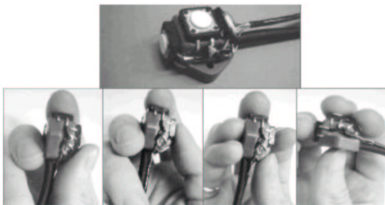
FIG. 2.2 – Une bat équipée de plusieurs boutons, par Shaw et Green [107]
