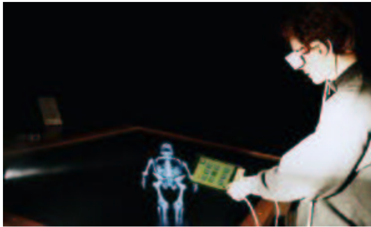
FIG. 5.2 – Le Virtual Remote Control sur la palette virtuelle de Coquillart et Wesche [31]
