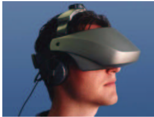
FIG. 1.3 – Visio-casque, modèle 5DT HMD 800-35 de la compagnie 5DT TM
