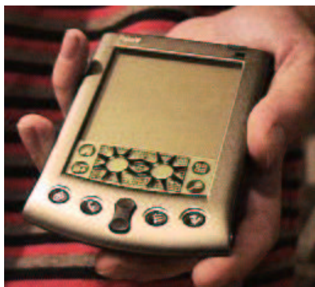
FIG. 4.3 – Un PDA (Palm V TM ) avec un masque pour QuikWrite, copyright Palm inc.
